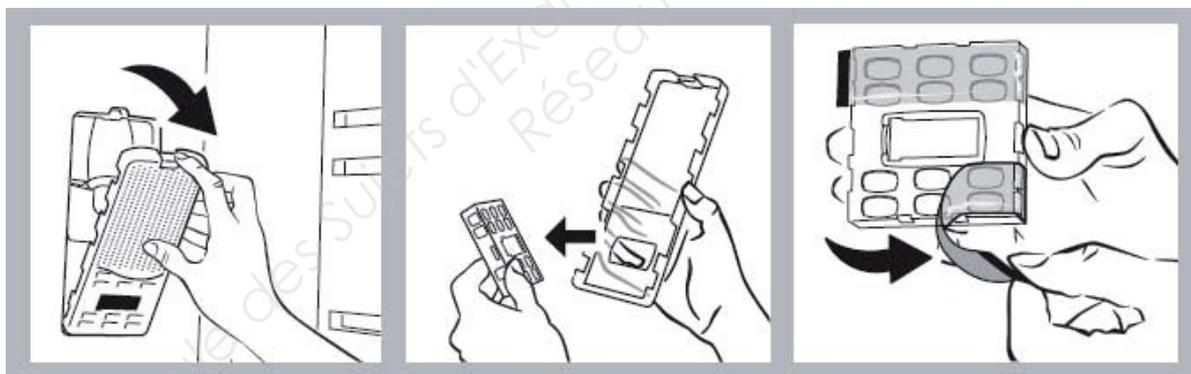
Le réfrigérateur peut être doté d'un filtre qui, d'une part, absorbe les odeurs pouvant émaner des aliments et qui, d'autre part, retient les micro-organismes (champignons et bactéries) présents dans l'air en circulation.
